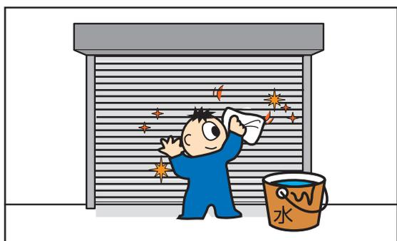
雨などにより、泥、ほこりなどが付着しますと錆の発生を早めます。カーテンおよびガイドレールが汚れた場合は、濡れた布などで汚れを落とした後、固く絞った布などで水分を拭き取ってください。
